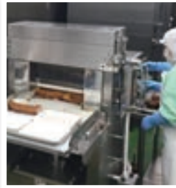
チャーシュースライス設備 郡山工場
